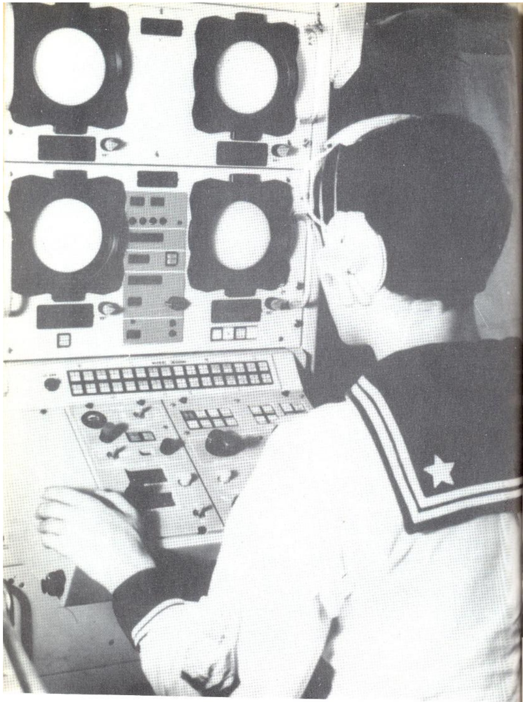
Consola operativa de un sistema integrado naval ESM/ECM.
