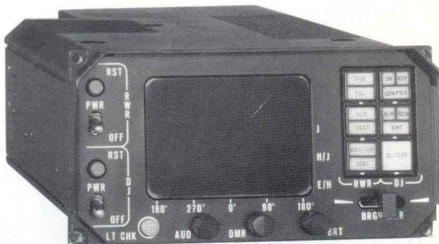
Unidad de presentación de alarma radar (RWR ELT/161) para sistema integrado ESM/ECM. (Ver texto pág. 135)
