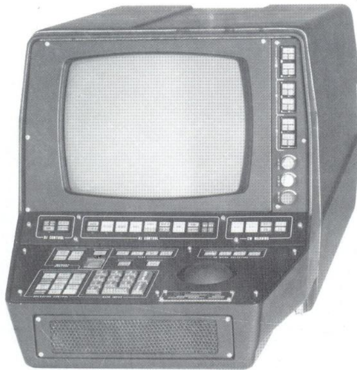
Consola operativa de un sistema integrado ESM/ECM aerotransportado (ELT/261).
