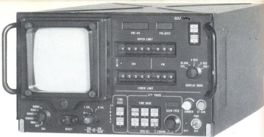
Unidad de análisis para la medida de PRF y PW (ELT/777).
