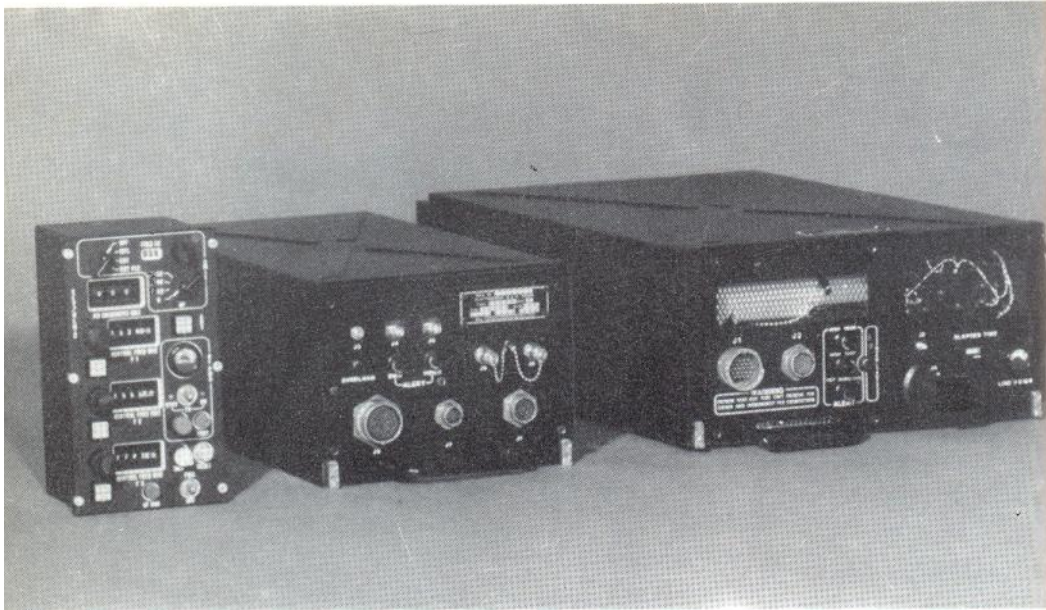
Sistema típico de perturbación aerotransportado de Elettronica S.p.A. (de izquierda a derecha: Panel de control, unidad piloto y unidad transmitente).
